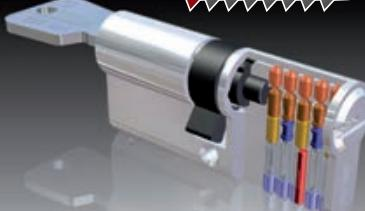
**Elementi sigurnosti mehanizma:** 10 elementa u mehanizmu zaključavanja / 5 aktivnih klinova na opruzi / 5 vertikalnih kontrolnih klinova ■ **100.000 kombinacija** ■ **4 Ključa od novog srebra** ■ **Horizontalni profil** ■ **Otporan na provalničke tehnike:** Potiskivanje klinova / Češljanje / Bušenje - zaštita od bušenja tijela / Bumping ■ **Izrada ključeva:** kopiranje ključeva u tvornici te kod velikog broja servisnih centara
