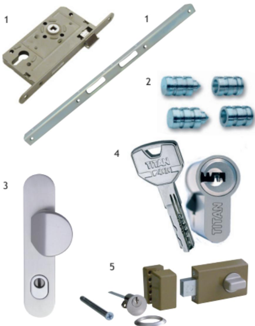
1. **Robusna brava** po mogućnosti s podizačem i anti-panik funkcijom + **robusni prihvatnik** "L" oblika, od čelika, 3 mm debljine, usidren kroz zid oko vrata s do 10 vijaka - onemogućuje provalu polugom;
