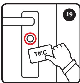
**Schritt 19** Prüfen Sie das Ergebnis, in dem Sie alle TMC oder TAG vor die EK halten. Sollte der EK „grün“ signalisieren wiederholen Sie Schritt 18.
