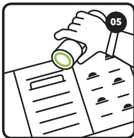
**Schritt 5** Zur Prüfung ob der passende TAG berechtigt ist, halten Sie erneut die zugehörige TMC an den EK. Blinkt der EK nach dem Zeigen der TMC „grün“ ist der TAG berechtigt. Blinkt der EK „rot“ ist der TAG unberechtigt. In diesem Falle wiederholen Sie bitte Schritt 4 mit der zugehörigen TMC.
