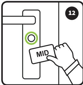
**Schritt 12** Halten Sie die MID vor den EK. Warten Sie die Signalisierung ab. Nachfolgend halten Sie die MID ein erneutes Mal vor den EK. Gehen Sie direkt zu Schritt 13 über
