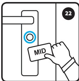
**Schritt 22** Halten Sie die MID ein Mal vor den EK und warten Sie die Signalisierung ab. Danach halten Sie die MID dauerhaft an den EK. Der EK blinkt erst 3 X grün und anschließend pro Sekunde 1 X blau. Jedes blaue Blinken entspricht dabei einer Sekunde Zeitintervall zum Öffnen und Verschließen. Halten Sie die MID entsprechend des gewünschten Zeitintervalls vor den EK und entfernen Sie diese anschließend.
