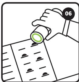
**Schritt 6 (Optional)** Optional können Sie auch die „Schließfunktion“ des TAG ausprobieren. Hierzu den TAG anstelle der TMC wie unter Schritt 5 beschrieben vorhalten. Der EK signalisiert „grün“ und kuppelt dabei für 5 Sekunden ein.
