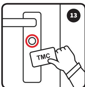
**Schritt 13** Halten Sie die TMC des verlorenen TAG vor den EK. Warten Sie die Signalisierung ab.
