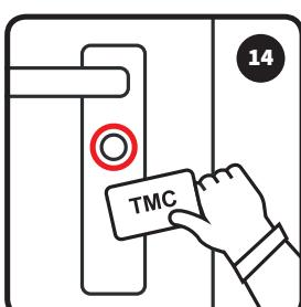
**Schritt 14** Prüfen Sie ob der verlorene TAG gelöscht wurde. Hierzu die entsprechende TMC vor den EK halten. Der EK sollte nun „rot“ signalisieren. Falls nicht wiederholen Sie bitte ab Schritt 12.
